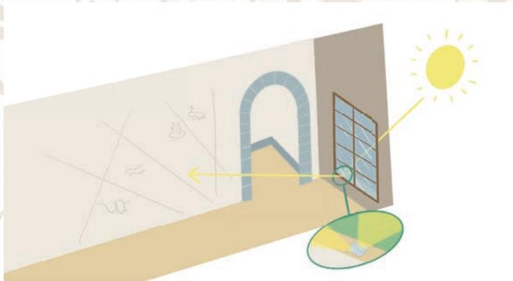
Le soleil se reflète sur un petit miroir placé à l'appui de la fenêtre et donne une tache lumineuse qui, en passant sur les lignes des murs et du plafond, indique l'heure solaire, le mois et le signe du zodiaque.
