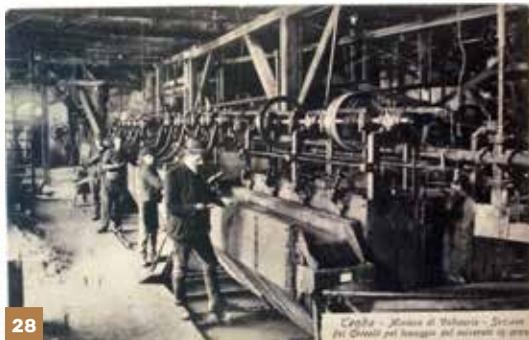
les "tables jumelles", puis les "tables à secousses", ensuite les "cribles à secousses", les "round-buddles", et enfin les
