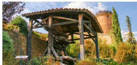
Ce type de pressoir est appelé pressoir à perroquet. Ce pressoir date de la fin du 19<sup>e</sup> s. Il ne reste que très peu d'exemplaires de ce mécanisme en France. Il fonctionnait de la manière suivante : un homme montait sur la première roue, afin de mettre en action une seconde roue, qui elle-même actionnait les presses. On pouvait grâce à ce système presser près de 1,5 tonne de raisin à la fois. Le jus se déversait par le bec du pressoir : d'où l'origine du nom de ce pressoir.
