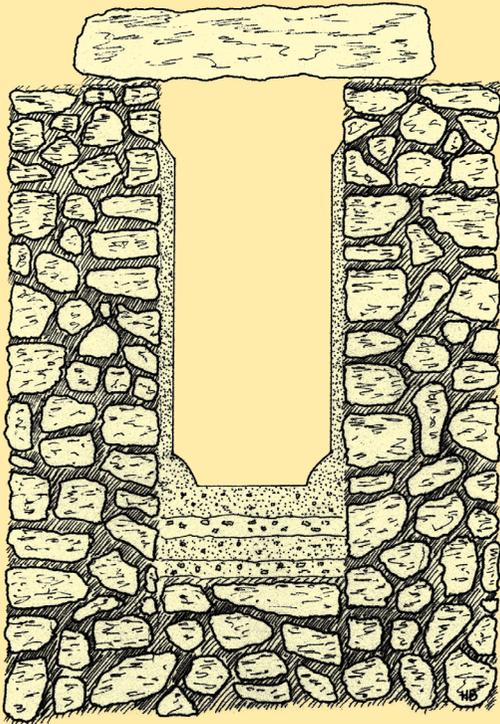
L'aqueduc est un canal de section rectangulaire, plus haut que large, en faible pente (de l'ordre de 1 pour 1000), où l'eau coule par gravité à vitesse modérée (moins de 1 m/s).
