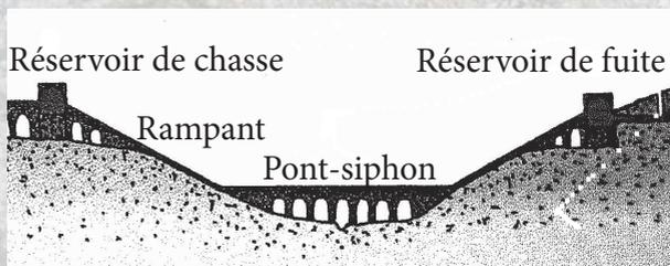
Dans cette vallée, les tuyaux passent sur le pont siphon. Puis ils remontent sur le côté opposé jusqu'au réservoir de fuite, construit plus bas que le précédent. Le canal reprend ensuite son parcours.
